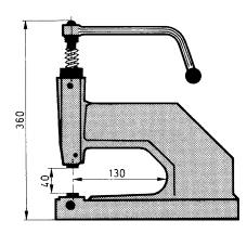
$\mbox{Alésage $\varnothing$ 12,3 mm} \\ \mbox{Taraudage du piston $\varnothing$ 6,2 x 110 mm} \\ \mbox{}$
