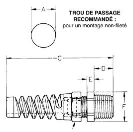
écrou d'étanchéité avec embout qui protège la flexibilité
